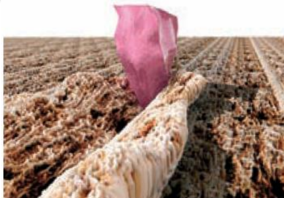
Aluminiumoxid-Körnung pflügt durch Weichholz.
