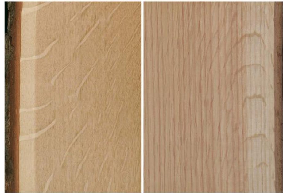
Holz vom Typ Weißeiche (links) und Roteiche (rechts) ( Quercus spp.): Radiale Oberfläche (natürliche Größe) mit deutlichen Spiegeln der großen Holzstrahlen
